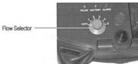
Рисунок 6– Установка регулятора потока
