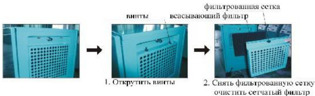
Очистка сетчатого фильтра
