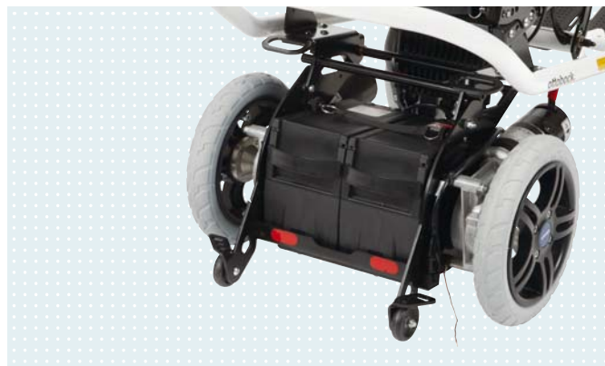
• Запатентованный съемный механизм аккумуляторов
