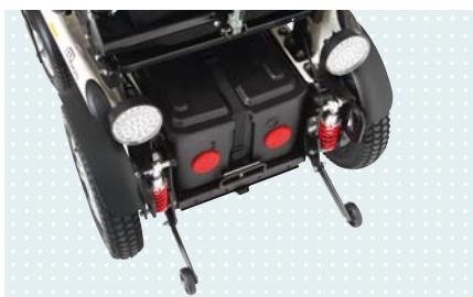
• Амортизаторы, отсек для аккумуляторов
