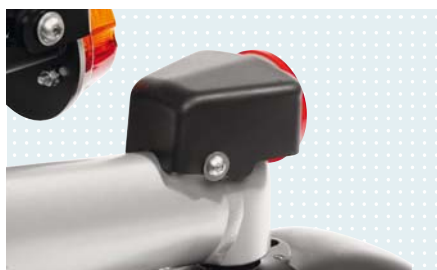
• Механический ограничитель поворота передних колес
