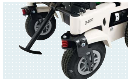
• Устройство для преодоления препятствий высотой до 10 см
