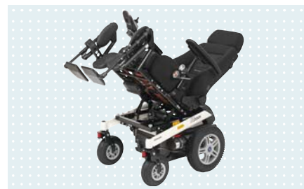
• Электрорегулировка угла наклона сиденья 45° со смещением центра тяжести
