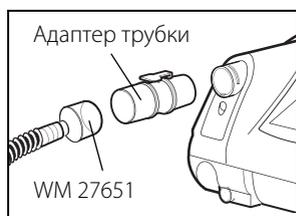
Подключение проточной системы трубок для искусственной вентиляции через загубник (WM 27651) выполняется следующим образом:
