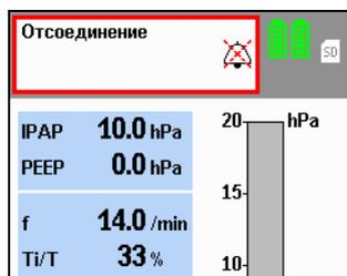
После квитирования звукового сигнала снова появляется стандартная индикация. Еще не устраненные неисправности продолжают отображаться в строке состояния и мигает (или горит) сигнальный светодиод, пока неисправность не будет устранена.
