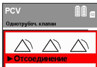
Если в результате неполадки подается сигнал (здесь: сигнал отсоединения), то можно нажатием клавиши квитирования сигналов
