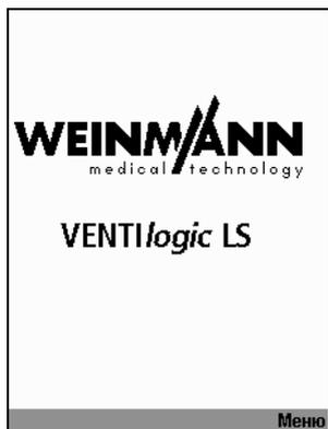
1. Подключите аппарат с помощью сетевого провода к сетевому питанию. Спустя около 5 секунд на дисплее появляется экран резервного режима.
