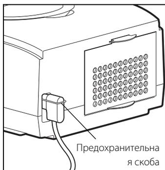
1. Подсоедините сетевой провод к сетевому разъему аппарата.
