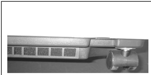
Губчатый **фильтр II** извлекается с помощью отвертки, расположен на боковых сторонах концентратора.
